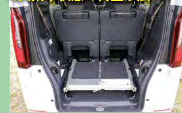
スロープは前倒し収納できるため荷室の床面はフラットで使いやすい
