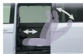
リフトアップシートの背もたれ角度およびシートポジションを電動調整できる電動リフトアップシート(リクライニング&スライド機構付)を装備しています。
