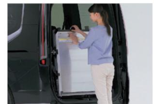
●車いすの種類・タイプ等により、乗車できない場合もあります。●車いすご利用の方の乗降は、介助の方が安全に心がけ確実に行ってください。●スロープは水平で平坦な路面でご使用ください。●スロープの耐荷重は200kgです。「車いす+車いすご利用の方+介助する方」の合計重量が200kg以下であることをご確認ください。●安全のため、車いすご利用の方もシートベルトを必ず着用してください。●発進前に再度、車いすが確実に固定されているか、ご確認ください。●スロープの展開は、接地するまで手を放さないでください。●スロープの操作は周りに十分注意して行ってください。●長時間のドライブや悪路での走行は、車いすご利用の方にとってご負担となる場合があります。
