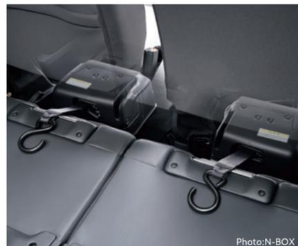
電動ウインチ (速度調整機能・進路補正付)
