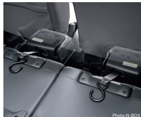
電動ウインチ(速度調整・進路補正機能付)
