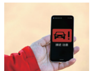
歩行者端末HMI (ヒューマン・マシン・インターフェース)
