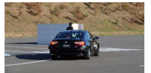
「Honda SENSING 360」は見通しの悪い交差点で交差車両がいることを検知してドライバーに知らせたり、右左折時に歩行者を検知すると衝突軽減ブレーキが作動する
