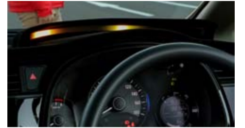
横断歩道にさしかかると、歩行者だけでなく、その後から横断歩道を渡るようとする自転車の存在も知らせてくれる「知能化運転支援技術」の一例。ドライバーが外界の何を認知し、何を認知していないのかを AI が理解し、メーターパネル上のリスクインジケーターやシートベルト張力の連続変化で伝達する
