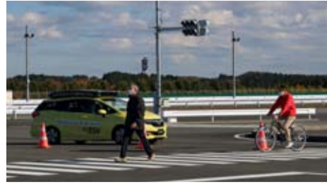
横断歩道にさしかかると、歩行者だけでなく、その後から横断歩道を渡るようとする自転車の存在も知らせてくれる「知能化運転支援技術」の一例。ドライバーが外界の何を認知し、何を認知していないのかを AI が理解し、メーターパネル上のリスクインジケーターやシートベルト張力の連続変化で伝達する
