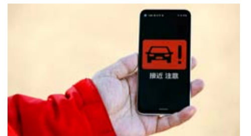
車載カメラで車道へ進入する歩行者を特定すると、車両などから歩行者の携帯端末に警報を送信し、歩行者の飛び出しを抑制するという「安全・安心ネットワーク技術」の一例が公開された
