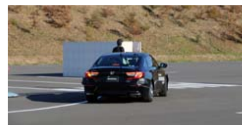
「Honda SENSING 360」は見通しの悪い交差点で交差車両がいることを検知してドライバーに知らせたり、右左折時に歩行者を検知すると衝突軽減ブレーキが作動する
