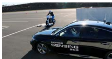
「Honda SENSING 360」は見通しの悪い交差点で交差車両がいることを検知してドライバーに知らせたり、右左折時に歩行者を検知すると衝突軽減ブレーキが作動する
