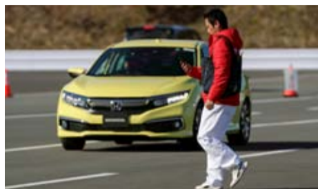
車載カメラで車道へ進入する歩行者を特定すると、車両などから歩行者の携帯端末に警報を送信し、歩行者の飛び出しを抑制するという「安全・安心ネットワーク技術」の一例が公開された
