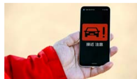
車載カメラで車道へ進入する歩行者を特定すると、車両などから歩行者の携帯端末に警報を送信し、歩行者の飛び出しを抑制するという「安全・安心ネットワーク技術」の一例が公開された
