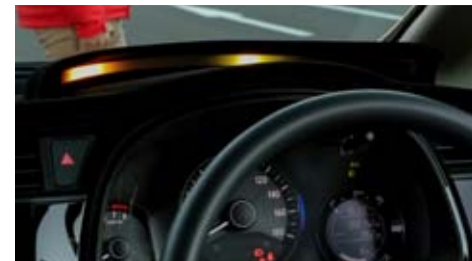
横断歩道にさしかかると、歩行者だけでなく、その後から横断歩道を渡るようとする自転車の存在も知らせてくれる「知能化運転支援技術」の一例。ドライバーが外界の何を認知し、何を認知していないのかを AI が理解し、メーターパネル上のリスクインジケーターやシートベルト張力の連続変化で伝達する
