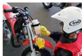
燃料タンクに貼り付けた目盛でガソリンの消費量を確認
