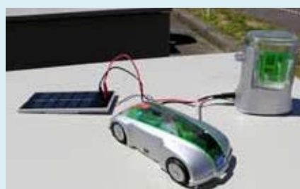
太陽電池パネルが水を電気分解し、水素を発生させる
