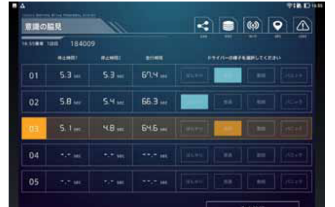
各周回の停止時間と走行時間はタブレット端末に表示される
