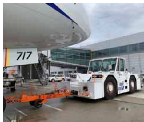
航空機牽引車。航空機の地上移動の際に使用される。航空機の前輪を抱え込んで作業するもの（左）とトローパー（航空機と車両をつなげる金属の棒）を使用して作業するもの（右）（写真提供: ANA）
