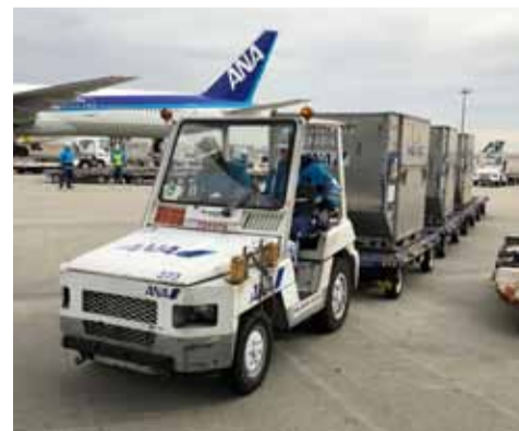
航空機に載せるコンテナを積んだドーリーなどを牽引するトローイングトラクター（写真提供: ANA）
