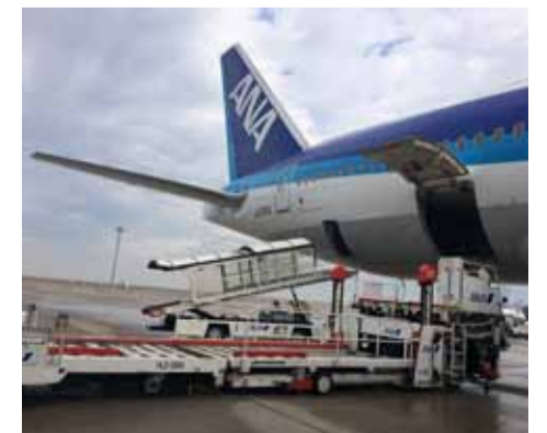
航空機へコンテナなどを搭降載するハイリフトローダー（写真提供: ANA）
