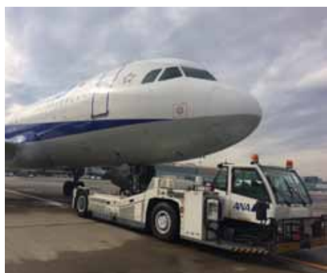
航空機牽引車。航空機の地上移動の際に使用される。航空機の前輪を抱え込んで作業するもの（左）とトローパー（航空機と車両をつなげる金属の棒）を使用して作業するもの（右）（写真提供: ANA）
