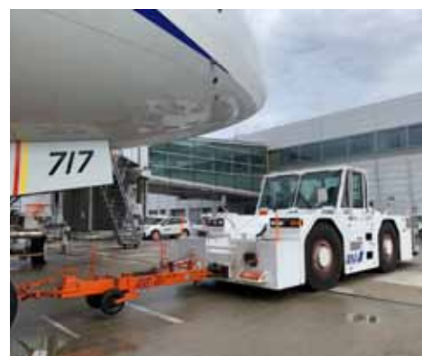
航空機牽引車。航空機の地上移動の際に使用される。航空機の前輪を抱え込んで作業するもの（左）とトーパー（航空機と車両をつなげる金属の棒）を使用して作業するものがある（右）（写真提供：ANA）
