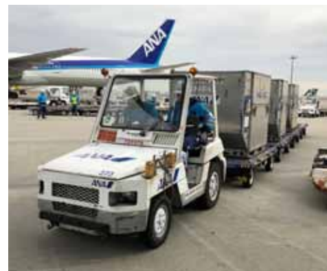
航空機に載せるコンテナを積んだドーリーなどを牽引するトーイングトラクター（写真提供：ANA）
