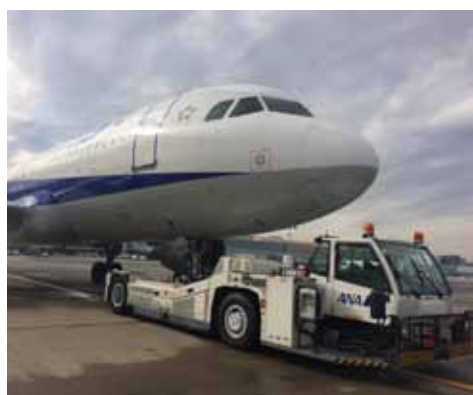
航空機牽引車。航空機の地上移動の際に使用される。航空機の前輪を抱え込んで作業するもの（左）とトーパー（航空機と車両をつなげる金属の棒）を使用して作業するものがある（右）（写真提供：ANA）
