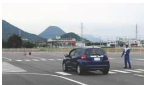
正面の信号点灯を確認してから急ブレーキをかけて止まり、受講者の停止距離を測定
