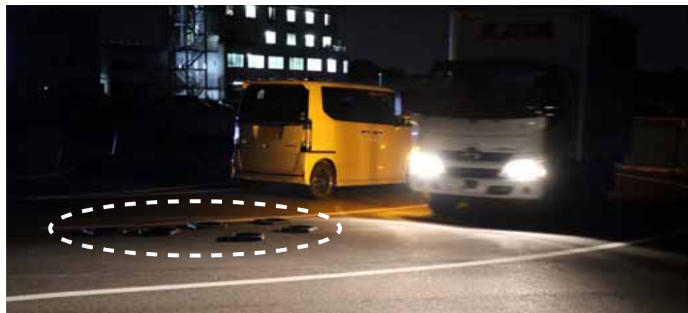
ゴム製のパイロンウエイト（点線）を使用した路面の夜間視認性を確認する走行
