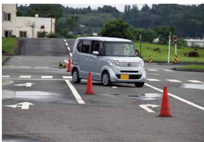
パイロンスラロームなどで複数の課題(指定された速度を維持しているか、適切なハンドル操作ができていないかなど)を同時に遂行できる能力を評価
