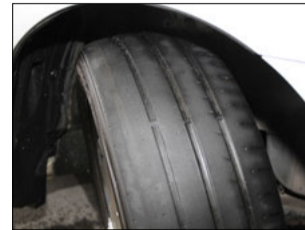
溝が浅くなったタイヤをトレーニング車両の前輪または後輪に装着
