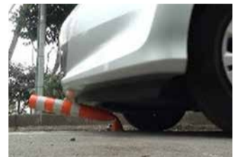
車両が衝突しても損傷しないよう、ボラードの素材は弾力性のあるゴム製を採用
