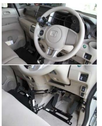
トレーニング車両に取り付けられた左手・左足で操作するための運転補助装置
