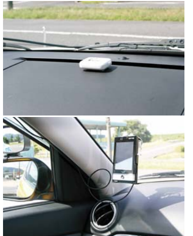
車内に取り付けられたGPSアンテナ(写真上)とデータを集めるためのPDA(携帯情報端末)。取り外しが可能なので、どの車両にも対応できる
