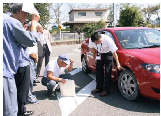
低空気圧のタイヤだと側面までも接地してしまい危険だということを指導員が説明した
