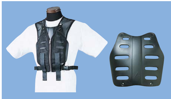
Hondaボディプロテクター(メッシュ地のベストタイプ)。白バイ隊員も利用している。ベストの中に入っているフロントガードシェル(写真右)は内部を空洞(中空構造)にすることで軽量化しながら剛性を高められている。詳しくは以下のホームページを参照。 http://www.honda.co.jp/bike-accessories/wear/protector/
