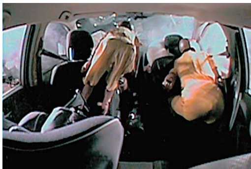
ステーションワゴンを64km/hで壁に正面衝突させた2回目のテスト
