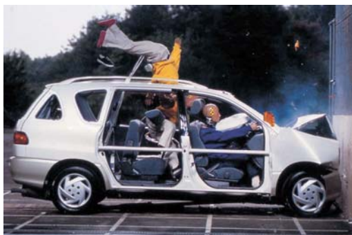
ミニバンを50km/hで壁に正面衝突させた1回目のテスト
