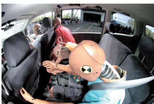
出会い頭事故を想定した3回目のテスト。写真は45km/hで衝突したミニバンの車内
