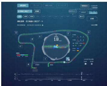
アクセルやブレーキ、ウインカーの操作状況、加減速時などに発生する G (加速度)、コースの走行軌跡を測定したデータと客観 VS 自己評価が比較された評価表を配布 (1 回目)
