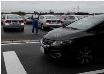
DSP システムを搭載した車両を運転、指定されたコースを走行。 コースは 1 周約 800m。一時停止場所や急カーブ、上り下り、右左折、横断歩道の通過など 9 カ所のチェックポイントを通る
