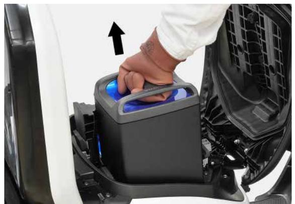
④ 同様にハンドルを右に傾けて、左側の動力用バッテリーを引き抜く。
