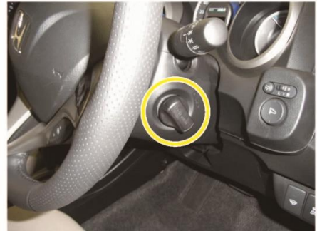
Hondaスマートキー装備車のイグニッションスイッチ部。キーではなくノブになっています。
