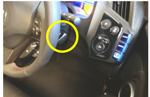
Hondaスマートキー装備車のイグニッションスイッチ部。キーではなくノブになっています。
