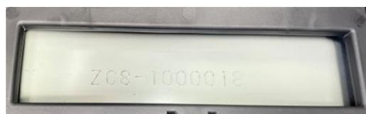
カバーを手前から開くと型式およびフレームナンバーが確認できます
