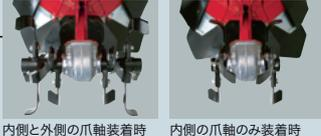
内側と外側の爪軸装着時 内側の爪軸のみ装着時
