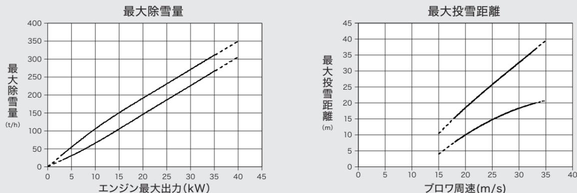
※グラフは目安です。雪質など使用条件により最大除雪量、最大投雪距離は異なります。グラフは除雪機安全協議会会員の2017年モデルのデータを基に作成しています。
