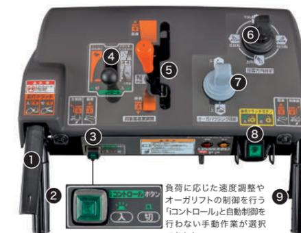
負荷に応じた速度調整やオーガリフトの制御を行う「コントロール」と自動制御を行わない手動作業が選択できます。 Photo:HSS1370i(JX)
