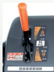
手元のレバーひとつで簡単にオーガ高さを手動調整(ガス圧アシスト付)。
