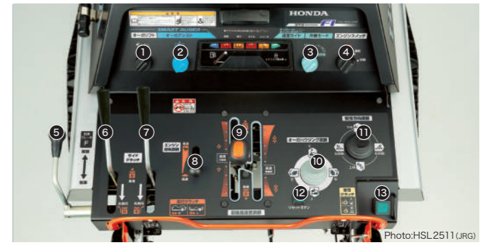
Photo:HSL2511 (JRG) ①オーガリフトスイッチ ②オーガアシストスイッチ ③除雪作業モード切替スイッチ ④エンジンスイッチ ⑤駐車ブレーキレバー ⑥サイドクラッチレバー(左側) ⑦サイドクラッチレバー(右側) ⑧エンジン回転調節レバー ⑨前後進速度調節レバー ⑩オーガハウジング調節スイッチ ⑪投雪方向調節スイッチ ⑫リセットボタン ⑬除雪クラッチスイッチ
