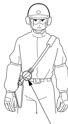
バンド先端部を巻き込み固定
