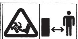
**Le lame della fresa sono affilate e girano ad alta velocità. Il contatto accidentale può causare ferite gravi.**
