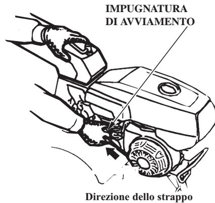
6. Lasciar riscaldare il motore per alcuni minuti. Se il pomello dell'aria non è stato portato in posizione di CHIUSURA, riportarlo gradualmente nella posizione di APERTURA mentre il motore si riscalda.
