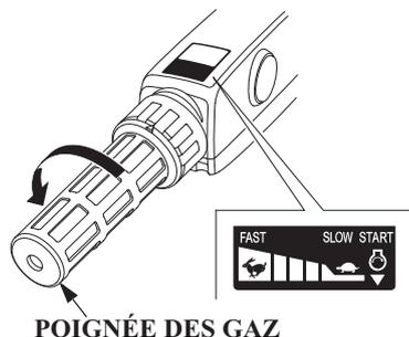
Tourner la poignée dans le sens des aiguilles d'une montre ou dans le sens contraire des aiguilles d'une montre pour régler la vitesse du moteur.
