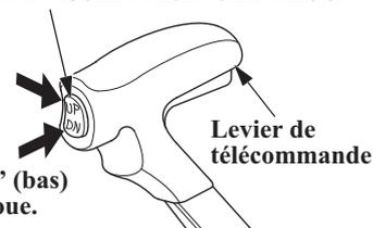
Les modèles BF75D/90D T sont équipés du commutateur d'assiette/inclinaison système qui peut ajuster l'angle du moteur hors-bord (angle de réglage/d'inclinaison) pendant la navigation et l'amarrage. L'angle du moteur hors-bord peut également être réglé pendant la navigation et l'accélération pour obtenir la vitesse maximale ainsi qu'une motricité et une économie de carburant optimales.
