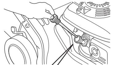
**Ne dépassez pas les limites de remplissage d'huile.** Si le moteur a trop d'huile, l'excédent pourrait se transférer au filtre à air et à ses pièces.
