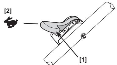
3. Avec le levier de commande de lame désengagé [2], tirez légèrement le démarreur [1] jusqu'à ce que vous sentiez une résistance puis tirez brusquement. Ramenez doucement le démarreur à sa position.
