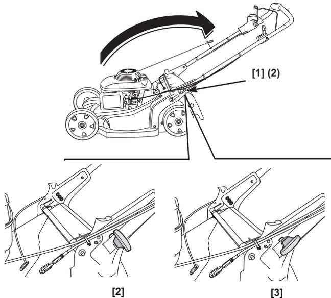
1. Tournez les boutons de réglage du guidon [1] sur 90 degrés en position de déverrouillage [2].
