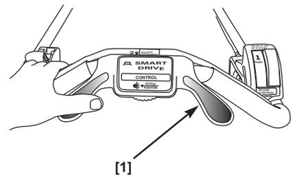
La vitesse d'avancement augmente avec la pression exercée sur la commande Smart Drive. Après avoir obtenu la vitesse d'avancement maximum, toute force additionnelle ne permettra pas d'augmenter cette vitesse. Exercez uniquement la pression nécessaire pour obtenir la vitesse souhaitée.
