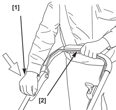
Tenez toujours le levier de la commande de lame contre le guidon pour maintenir la rotation de la lame.
