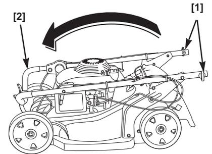
En pliant le guidon, prenez garde de ne pas pincer ni tordre le câblage des commandes.
