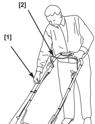
4. Placez le levier de commande des gaz [1] dans la position rapide [3] pour tonde ou dans la position lente [4] pour tourner au ralenti.
