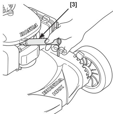
3. Examinez attentivement la bougie. Remplacez-la si les électrodes sont usées ou si l'isolant est fissuré ou cassé.
