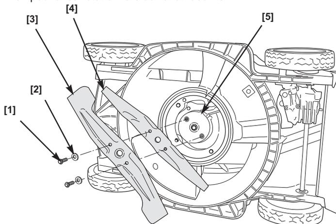
5. Retirez la lame supérieure de broyage [4] et la lame inférieure de broyage [3].
