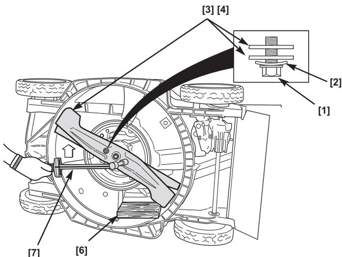
N'oubliez pas d'installer les rondelles spéciales avec le côté concave orienté en direction de la ou des lames et le côté convexe orienté vers la tête des boulons.
