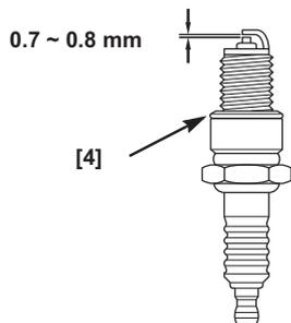
4. Mesurez l'écartement des électrodes avec une jauge appropriée. La distance doit être de 0,7 à 0,8 mm. Si un réglage est nécessaire, il suffit de tordre soigneusement l'électrode latérale.
