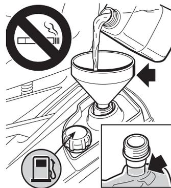
Unter Verwendung eines Trichters den Tank mit Kraftstoff füllen.
