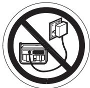
Dieser Vorgang kann zu lebensgefährlichen Stromschlägen für Beschäftigte des Stromversorgungsunternehmens oder andere Personen führen, die während eines Stromausfalls Netzeleitungen berühren. Außerdem kann der Generator bei erneuter Zuschaltung der Netzspannung explodieren, Feuer fangen oder einen Brand verursachen. Bevor Sie derartige Stromanschlüsse herstellen, setzen Sie sich mit dem Stromversorgungsunternehmen oder einem Fachmann in Verbindung.
