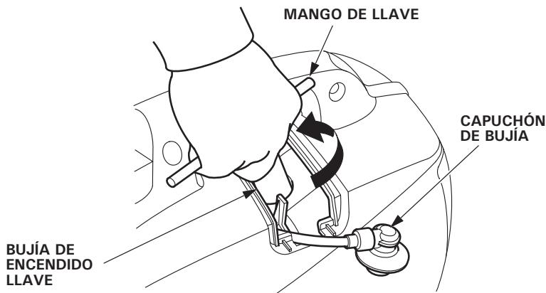
5. Inspeccione visualmente la bujía. Tírela si el aislador está agrietado, partido, o muy sucio. Limpie la bujía con un cepillo de alambre si debe volver a utilizarla.
