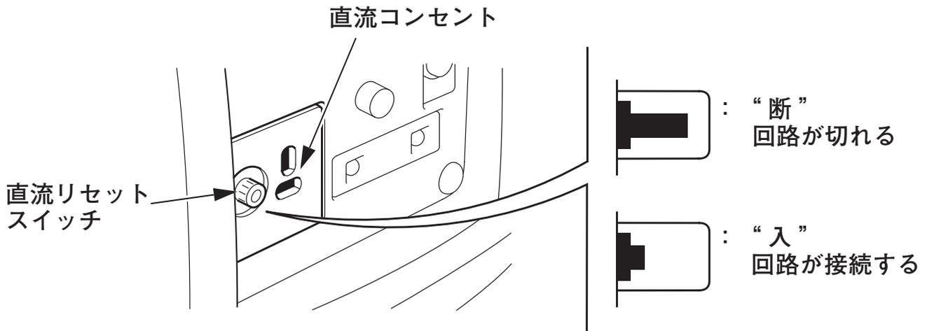
直流コンセントは直流電気を取出すところで、12 V バッテリーの充電専用です。交流電気を使用している場合でも直流電気を取出すことができます。
