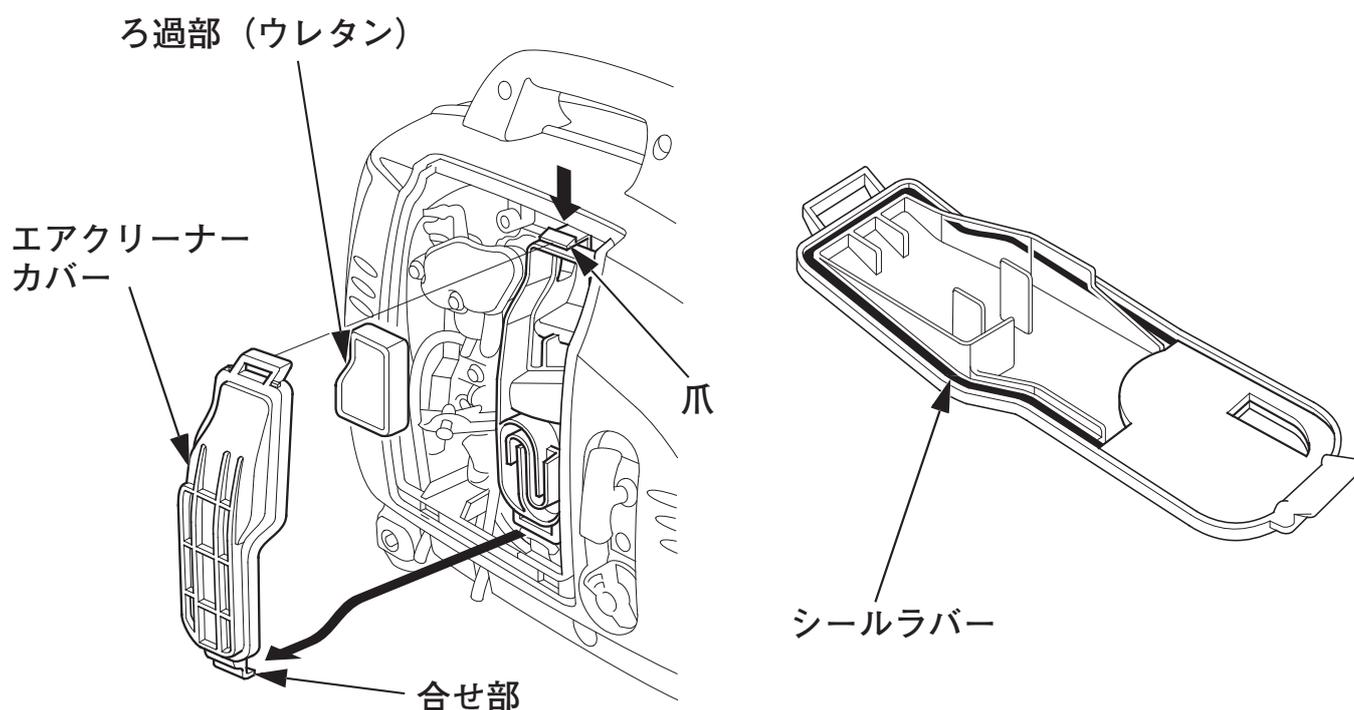
4. エアクリナーカバーに取付けられたシールラバーに損傷がないこと、また確実に取付けられていることを確認します。
