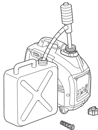
4. キャブレター（気化器）、燃料ポンプ内のガソリンを抜きます。
