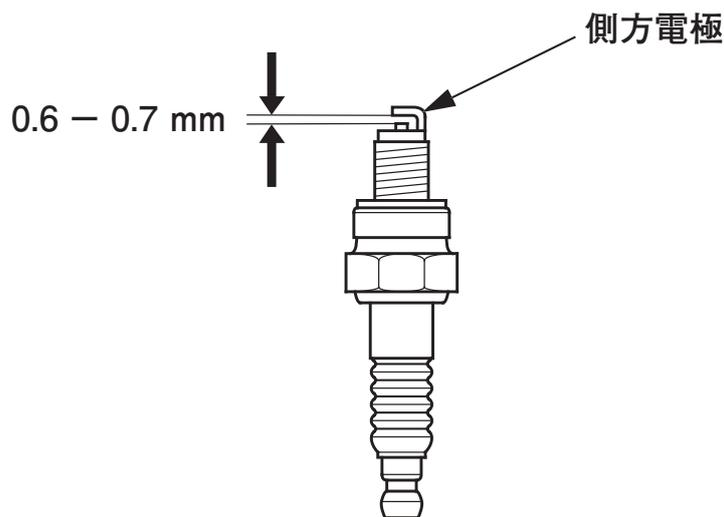
6. 取付けはまず手で一杯までねじ込み、次にプラグレンチで確実に締付けます。
