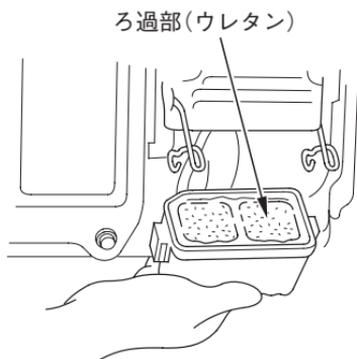
3. ろ過部(ウレタン)とエア クリーナ カバーを確実に取付け、固定バネをセットします。
