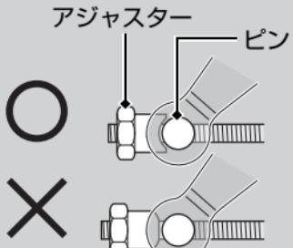
2. ブレーキアームを押してアジャスターとピンの間に隙間があることを確認する。
