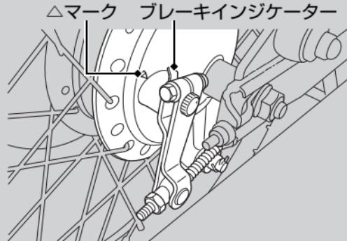
前輪はブレーキレバーをいっぱいに引いて、後輪はブレーキペダルをいっぱいに踏んで、ブレーキインジケーターの先端とブレーキパネルの△マークが一致しないことを確認します。
