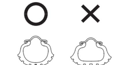
タイヤの空気圧は徐々に低下します。また、タイヤによっては空気圧不足が見た目ではわかりづらいものもあるため、少なくとも一カ月に一度はタイヤゲージを使用して空気圧の点検を行ってください。
