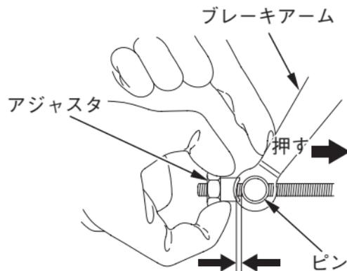
調整後は、ブレーキペダルの遊びを確認してください。
