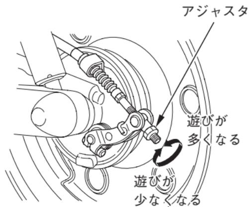
調整後、ブレーキアームを押してアジャスタとピンとの間に隙間があることを確認します。
