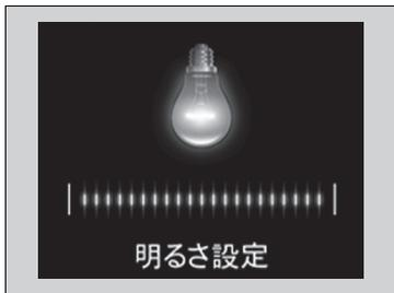
パワーモードが ON モードのときに、**+**/**-** ボタンでインストルメントパネルの明るさを調節することができます。
