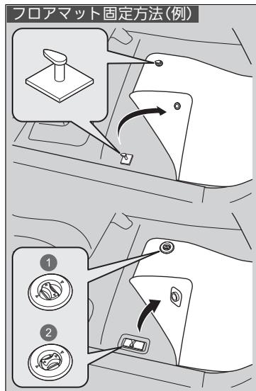
運転席のフロアマットが前方にずれるのを防止するため、フロアアンカーで確実に固定してください。
