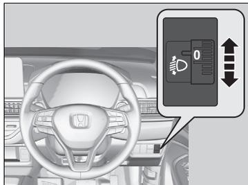
車幅灯が点灯しているとき、ヘッドライトの照らす方向(光軸)を下向きに調節することができます。
