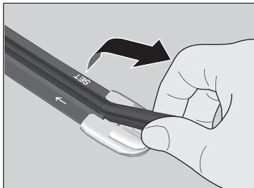
3. ラバーのストッパーがブレードのツメから外れるまで引き、そのままラバーをブレードから引き抜く。
