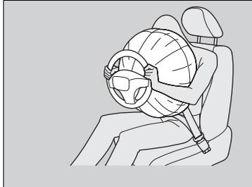
前方向から衝突すると、シートベルトが乗員の下半身と胴体を拘束し、SRSエアバッグが頭と胸部を保護します。
