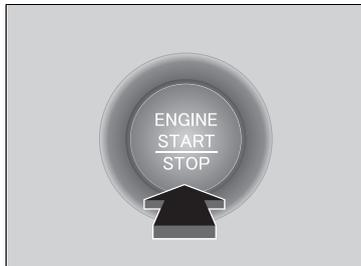
Honda スマートキーを携帯し、ブレーキを踏まずに **ENGINE START/STOP** を押しと OFF モード→アクセサリモード→ON モード→OFFモードの順にパワーモードが切り換わります。
