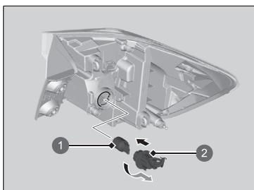
3. ソケットを左に回して外し、古い電球を抜き取る。
