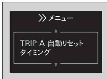
4. レフトセクターホイールを回し、「TRIP A 自動リセットタイミング」が表示されたら、レフトセクターホイールを押す。
