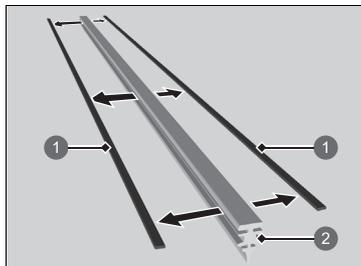
4. 引き抜いたラバーからリテーナーを外し、新しいラバーに取り付ける。
