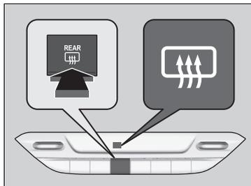
パワーモードが ON モードのときにスイッチを押すと、リヤガラスを暖め、曇りをとることができます。
