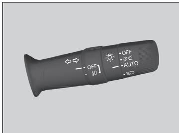
パワーモードがONモードのとき、ライトスイッチを **AUTO** にすると自動点灯が作動します。
