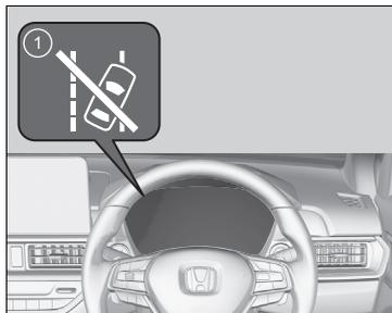
① 路外逸脱抑制機能操舵アシスト一時停止警告灯
