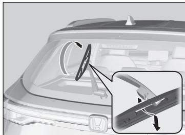
2. ワイパーブレードの底部を回転させ、アームのホルダー部からブレードを引き抜いて取り外す。
