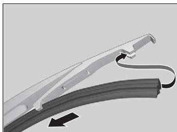
5. ブレード中央部のツメからラバーを挿入し、ブレード両端のツメにラバーを通す。
