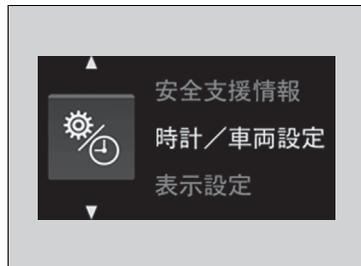
パワーモードがONモードでシフトポジションが[P]のときに、
