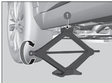
7. ジャッキの上部がジャッキポイントに接触するまで図の部分を実印の方向に回す。
