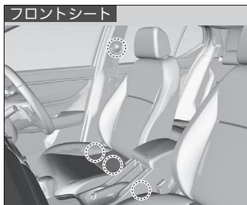
シートベルトを交換する場合、図の中で示されるアンカーポイントを使用してください。
