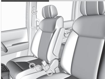
シートベルトを交換する場合、図の中で示されるアンカーポイントを使用してください。
