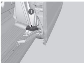
スライドドアの内側にあるカバーおよび内部の電線が傷つくと、作動不良の原因となります。踏まないように注意してください。
