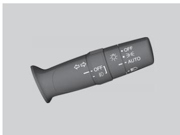
パワーモードがONモードのときに、ライトスイッチを **AUTO** にすると自動点灯が作動します。
