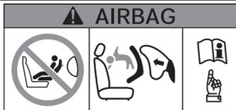
シート前方の作動可能なエアバッグで保護されたシートには、後ろ向きチャイルドシートを絶対に取り付けしないでください。
