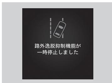
繰り返し歩行者事故低減ステアリングが作動しても運転者の操作がない場合は警報音が鳴ります。その後、左記の警告を表示し操舵アシストが一時停止して、警報音のみで警告します。
