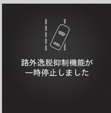
繰り返し路外逸脱抑制機能が作動しても運転者の操作がない場合は警報音が鳴ります。その後、左記の警告を表示し操舵アシストが一時停止して、警報音のみで警告します。
