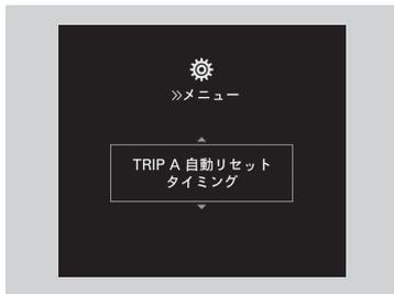
4. ライトセレクターホイールを回し、「TRIP A 自動リセットタイミング」が表示されたら、ライトセレクターホイールを押す。
