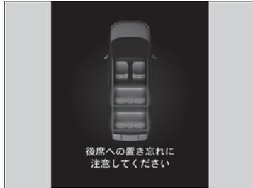
作動後、パワーモードをOFFモードにしたとき、マルチインフォメーションディスプレイにお知らせが表示され、音が鳴ります。
