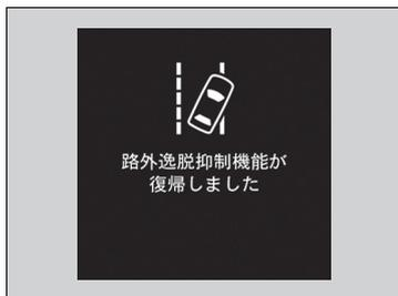
繰り返し路外逸脱抑制機能が作動しても運転者の操作がない場合は警報音が鳴りません。その後、左記の警告を表示し操舵アシストが一時停止して、警報音のみで警告します。
