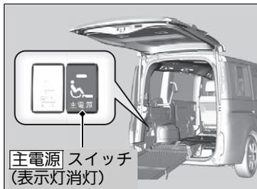
7. **主電源** スイッチを押してシステムを「OFF」にする。
