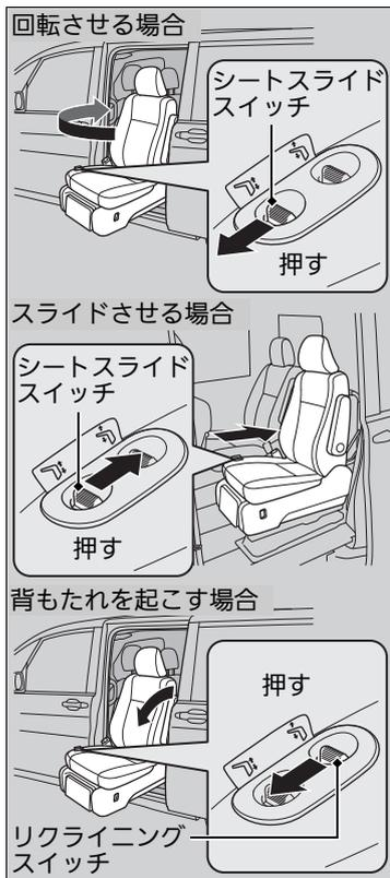
7. シートが車体に接触しないように前後左右を確認しながら、下記のスイッチ操作を交互に繰り返して「ピッ」とブザーが鳴る位置までシートを格納(後ろに下げる)する。
