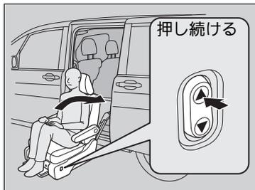
5. 回転 / 昇降ボタンの上側を押し続ける。リモコンを使用するときは、リモコンの電源スイッチを押しインジケータが点灯後、シート上昇スイッチを押し続ける。
