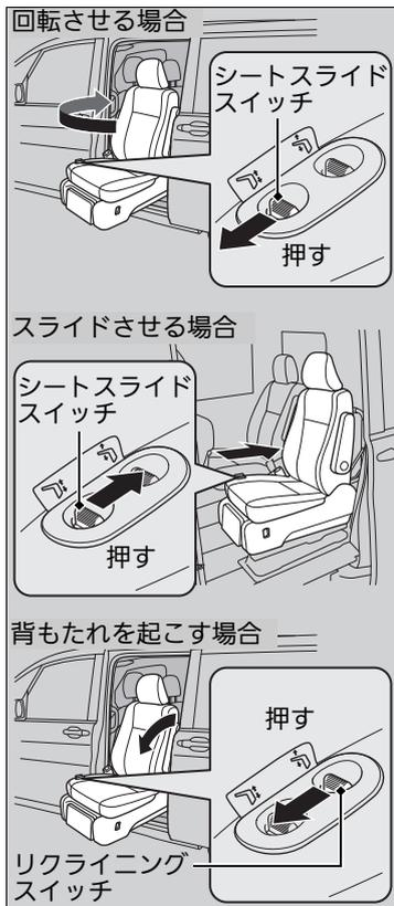
8. シートが車体に接触しないように前後左右を確認しながら、下記スイッチ操作を交互に繰り返して「ピッ」とブザーが鳴る位置までシートを格納(後ろに下げる)する。
