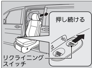
7. リクライニングスイッチを後側に押し続けて、シートが止まるまで車内側へ引き込む。
