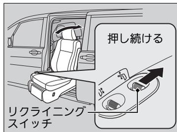
4. リクライニングスイッチを後側に押し続けて、シートが止まるまで車内側へ引き込む。
