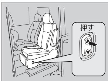
3. 回転 / 昇降ボタンの上側またはリモコンのシート上昇スイッチを押して、シートが走行位置 (格納位置) まで戻ったときに「ピピピッ」とブザーが鳴ること。
