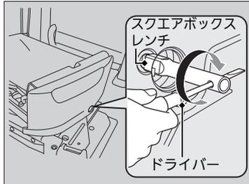
5. スクエアボックスレンチにドライバーを奥まで差し込み、昇降モーター回転軸を矢印の方向に回して、下降前の位置に戻す。
