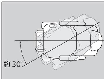
2. シートが回転を開始した直後から約 30°以下の位置で、回転 / 昇降ボタンまたはリモコンのスイッチから手を離すと、「ピピピッ」とブザーが鳴り続けること。
