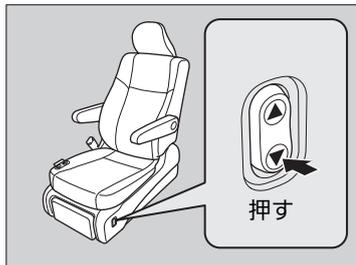
1. 回転 / 昇降ボタンの下側またはリモコンのシート下降スイッチを押して、シートが作動を始めるときに「ピーッ」とブザーが鳴ること。
