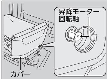
4. リフトアップシート後部にあるカバー右下のキャップを取り外し、昇降モーター回転軸の位置を確認する。
