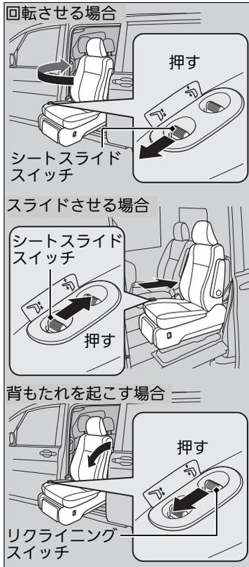
5. シートが車体に接触しないように前後左右を確認しながら、下記のスイッチ操作を交互に繰り返して「ピッ」とブザーが鳴る位置までシートを格納(後ろに下げる)する。
