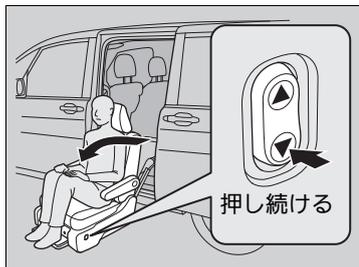
6. 回転 / 昇降ボタンの下側を押し続ける。リモコンを使用するときは、リモコンの電源スイッチを押しインジケータが点灯後、シート下降スイッチを押し続ける。
