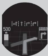
ナビゲーションシステムと連動して、交差点での曲がる方向や交差点までの距離を表示します。
