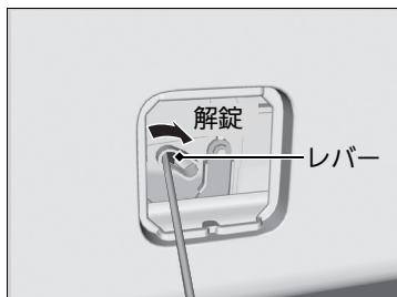
2. ドライバーを使ってレバーを右に動かしたままの状態で、テールゲートを押して開ける。
