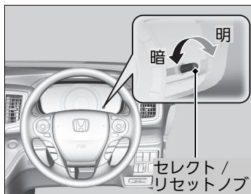
パワーモードがON モードのとき、セレクト / リセットノブでインストルメントパネルの明るさを調節することができます。
