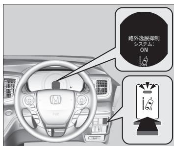
歩行者事故低減ステアリングは、路外逸脱抑制機能が ON のときに作動します。路外逸脱抑制スイッチを押して、歩行者事故低減ステアリングの ON と OFF を切り替えてください。
