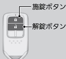
キーレスエントリーシステムを使用してパワーウィンドーの開閉が行えます。
