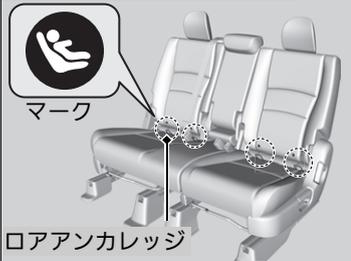
1. マークの下のシートの切れ目からロアアンカレッジを確認する。
