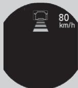
マルチインフォメーションディスプレイに車のアイコンが点線で表示されます。
