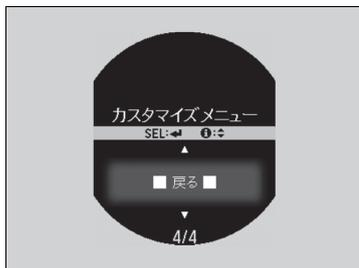
5. インフォメーション(**i**)スイッチ(▲/▼)を押し、「戻る」が表示されたら、**SEL/RESET** を操作する。
