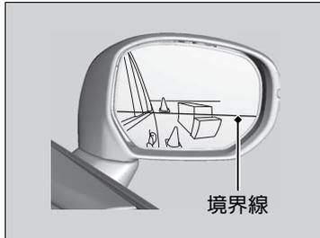
運転席側、助手席側ともにドアミラー面の下部についている曲率を変えたミラーにより、リヤタイヤ付近を見ることができます。
