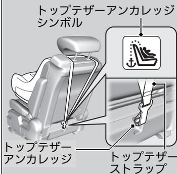
3. ヘッドレストを調節して最上段で固定し、トップテザーストラップをヘッドレストの外側に通す。
