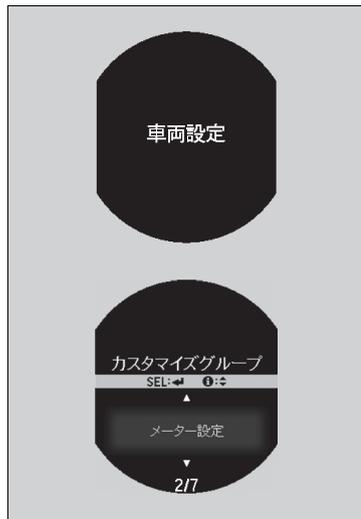
1. インフォメーション(ℹ)スイッチ(▲/▼)を押し、「時計\*/車両設定」が表示されたら、**SEL/RESET** を操作する。
