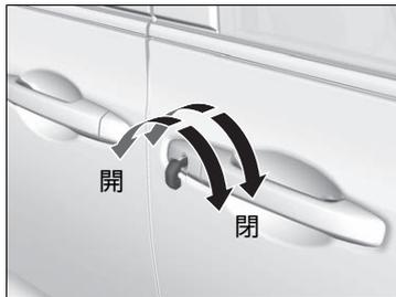
運転席ドアのキーシリンダーを使用してパワーウィンドーの開閉が行えます。
