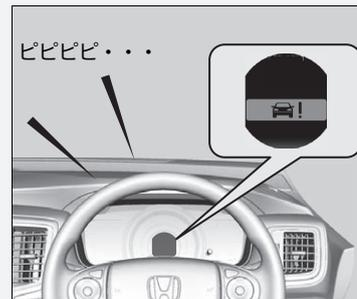
先行車または割り込み車の車速が自車よりも速く、次第に離れていく場合、先行車との距離が短くても警報が出ず、そのまま追従することがあります。
