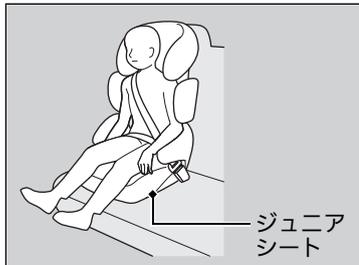
三点式シートベルトを使用できず、ジュニアシートを用いる必要があるお子さまは、ジュニアシートをセカンドシートまたはサードシートに設置して使用してください。
