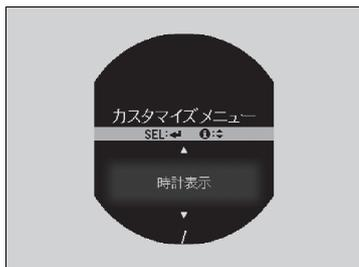
6. インフォメーション(ⓘ)スイッチ(▲/▼)を押し、「戻る」が表示されたら、**[SEL/RESET]**を操作する。
