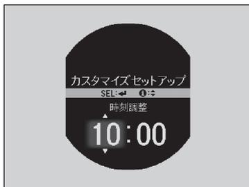
1. インフォメーション(ℹ)スイッチ(▲/▼)を押し、「時計/車両設定」が表示されたら、**SEL/RESET** を操作する。
