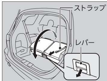
3. 下部のレバーを引きながら、ストラップを使ってシート全体を後方に倒す。
