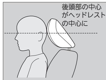
後頭部の中心が、ヘッドレストの中心に来るようにヘッドレストの高さを調整します。
