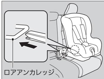
2. チャイルドシートを座席に置き、チャイルドシートの取扱説明書にしたがってロアアンカレッジに取り付ける。
