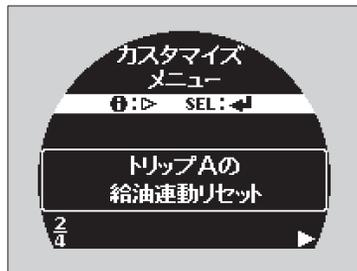
4. インフォメーション (i) スイッチを押し、「トリップAの給油連動リセット」が表示されたら、**SEL/RESET**を押す。
