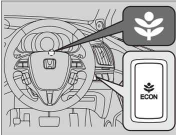
スイッチを押すとエンジン、CVT、エアコン、クルーズコントロールの作動を制御して、省エネ運転をしやすいように制御します。
