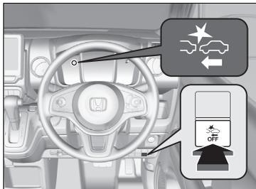
CMBS OFF スイッチを「ピーッ」とブザーが鳴るまで押すことで、システムのONとOFFを切り換えます。
