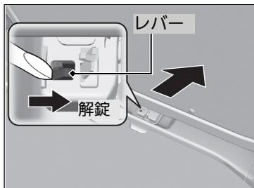
2. マイナスドライバーを使ってレバーを右に動かしたままの状態、テールゲートを押し開ける。
