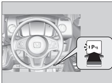
パワーモードが ON モードのときに、パーキングセンサーシステムスイッチを押して、システムの ON と OFF を切り換えます。
