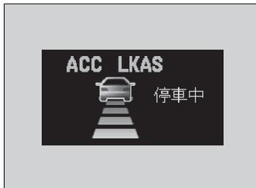
先行車が停車すると、自車も自動で停車します。マルチインフォメーションディスプレイにメッセージが表示されます。
