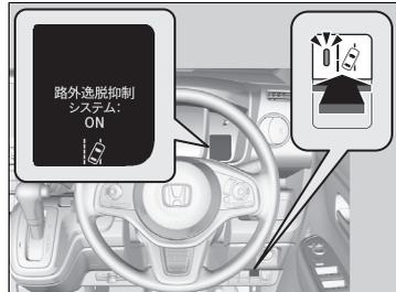
歩行者事故低減ステアリングは、路外逸脱抑制機能が ON のときに作動します。路外逸脱抑制スイッチを押して、歩行者事故低減ステアリングの ON と OFF を切り換えてください。
