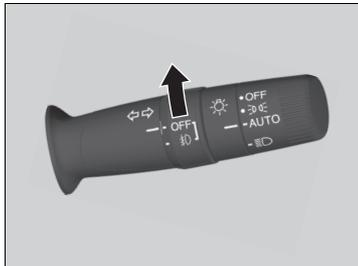
メーター内の☒インジケーターが点灯しているときに、フォグライトスイッチを回すと点灯します。
