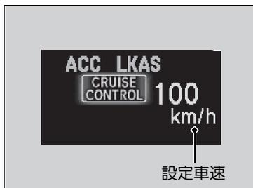
同時に、マルチインフォメーションディスプレイに CRUISE CONTROL と設定車速が表示されます。
