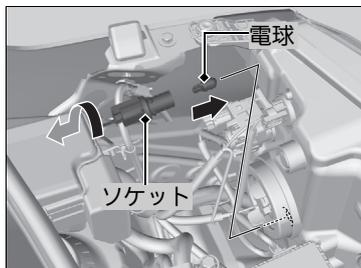
1. ソケットを左に回して外し、古い電球を抜き取る。
