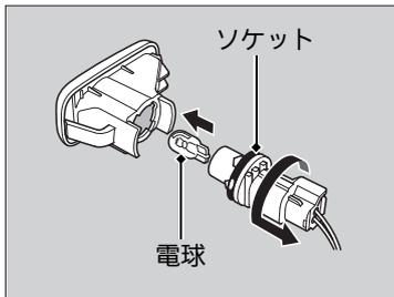
2. ソケットを左に回して外し、古い電球を抜き取る。
