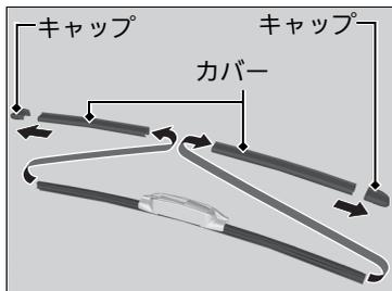
4. ブレードの両端のキャップとカバーを取り外す。
