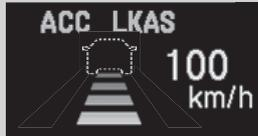
マルチインフォメーションディスプレイに点線の車のアイコンが表示されます
