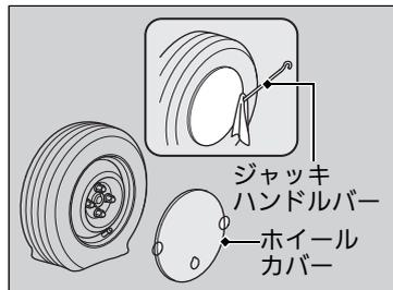
4. ジャッキハンドルバーの先を切り欠き溝に5～6cm差し込み、タイヤ側にこじってホイールカバーを外す。
