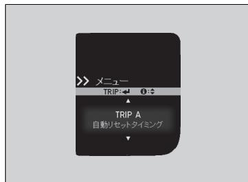
3. インフォメーション(**i**)スイッチ(**▲**/**▼**)を押し、「TRIP A 自動リセットタイミ」が表示されたら、**TRIP**を押す。
