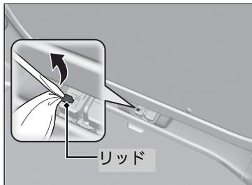
1. テールゲートのロック部分のリッドに、マイナスドライバーの先端を差し込み、リッドを開ける。
