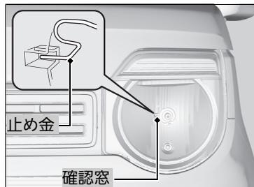
5. 止め金を元に戻し、ゴムカバーを取り付ける。
