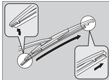
7. ブレードの先端のツメにラバーを通す。
