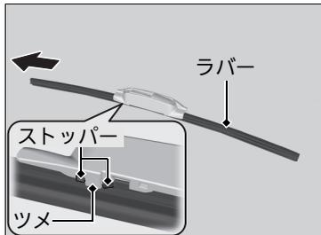
5. ラバーのストッパーがブレードのツメから外れるまで引き、そのままラバーをブレードから引き抜く。
