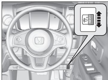
パワーモードがONモードのとき、ヘッドライトの照らす方向(光軸)を下向きに調節することができます。
