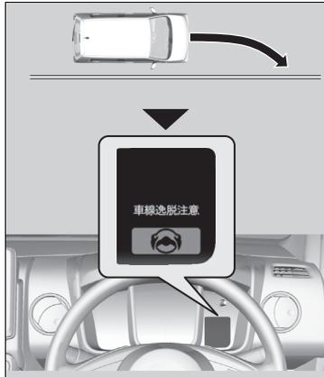
このシステムは、フロントガラス上部に設置されたカメラによって左右の白線または黄線を検知し、方向指示器(ウィンカー)を使用せずに白線(黄線)を逸脱したことを判断したとき、作動します。
