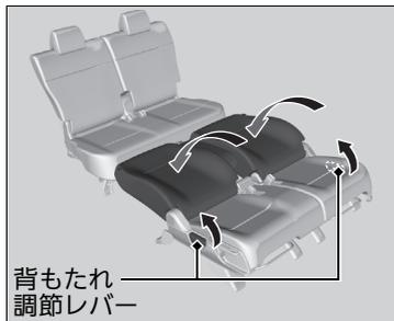
5. 背もたれ調節レバーを引き上げながら背もたれを後ろに倒して固定する。
