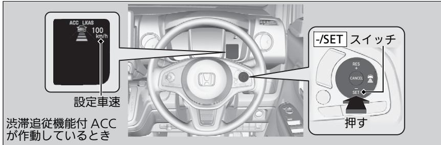
ブレーキペダルを操作していないときに **[-/SET]** スイッチを押すと現在の車速が設定車速とされ、渋滞追従機能付 ACC が作動し、マルチインフォメーションディスプレイにアイコンや設定車速が表示されます。
