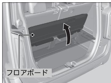
4. フロアボードの裏面に付いているローブをコンビニフックにかけます。
