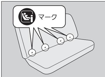
1. マークの下にあるシートの切れ目から下部取付金具を確認する。
