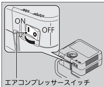
5. エアコンプレッサーの電源コードのプラグを、アクセサリースOCKETに差し込む。
