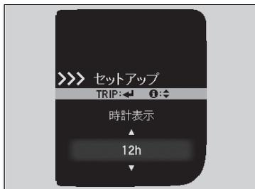
1. インフォメーション(❶)スイッチ(▲/▼)を押し、「時計 / 車両設定」が表示されたら、**TRIP**を押す。
