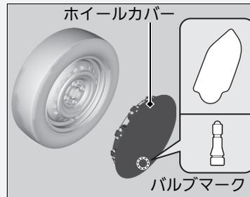
ホイールカバーを取り付けるときは、ホイールにあるタイヤバルブの位置にホイールカバーのバルブマークを合わせてから取り付けてください。
