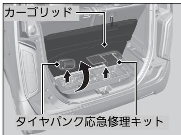
1. スライドボードとフロアボードを上げて、フロアボードを固定する。
